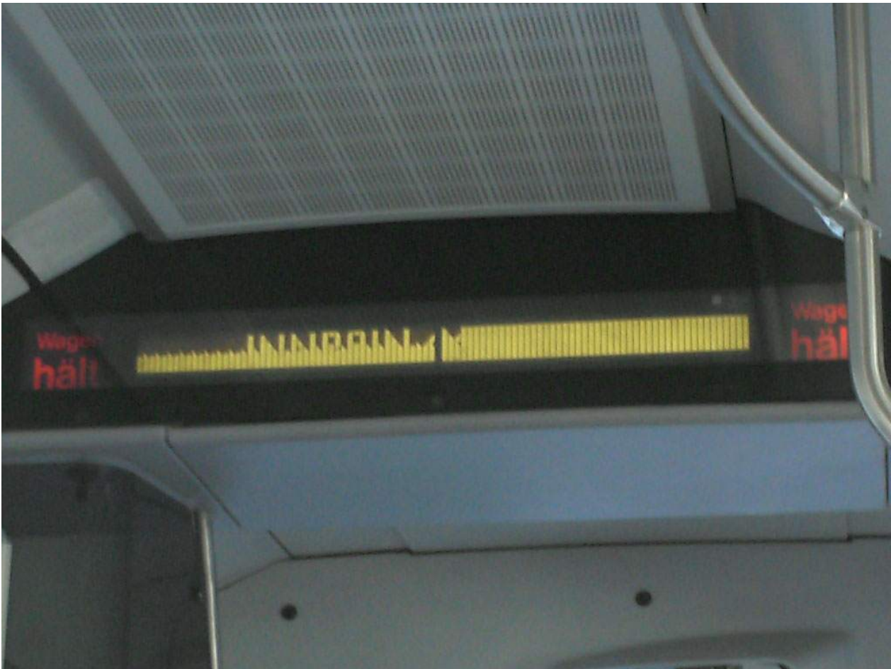
Bild 4: Defekte Innenanzeige für Fahrgastinformationen, monatelang nicht ausgewechselt.
